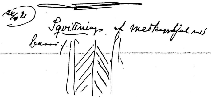
Första skissen över pilkugghjulet – en typiskt "slarvig" skiss.
